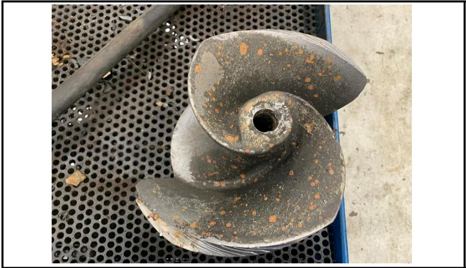
Impeller Disposition **Replace**
